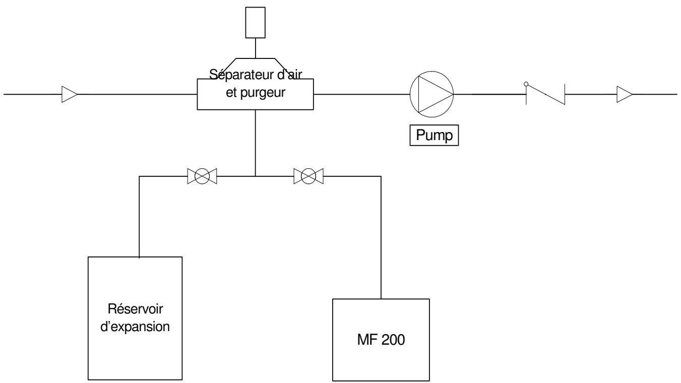
Schéma de raccordement – Ensemble d'alimentation MF
